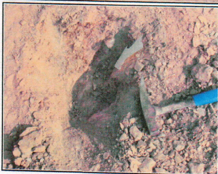
Obr.č. 8: Vlivem eroze prostupuje zvětralé břidlicové podloží až k povrchu cesty. Sonda prohloubena sbíjením do úrovně 0,3 m a ukončena v navětralé fylitické břidlici, pevnostní třídy R5-R4. Šipka sleduje strmý sklon břidličnatosti masivu.
